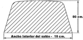
5. El panel debe ir instalado detrás de la primera fila de asientos y fijado a la estructura del vehículo con mínimo 4 anclajes en L.
