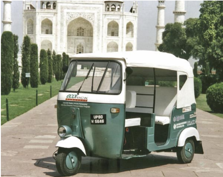
Hình 17: Xe ba bánh chạy điện "Ecorick" được phát triển trong chương trình IZET đang hoạt động ở Agra. Taj Mahal là một công trình nổi tiếng thế giới ở Agra. Không một xe động cơ đốt cháy trong nào được cho phép hoạt động trong khu vực lân cận công trình nổi tiếng này nhằm để bảo vệ công trình tránh khỏi sự ô nhiễm. Xe được sử dụng đặc biệt cho các du khách - những người gặp khó khăn về thể chất. Một vài xe này đã và đang hoạt động thành công ở Agra trong hai năm gần đây để chuyên chở các du khách đến các công trình nổi tiếng khác nhau. Minh hoạ của N.V.Iyer
