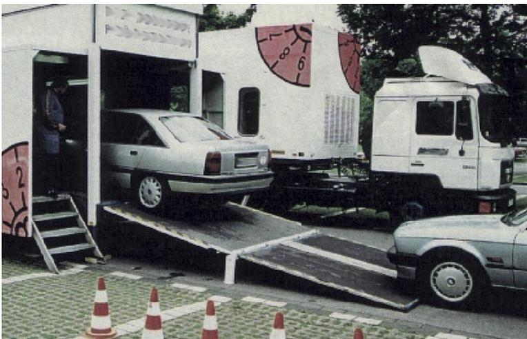
这种检测分为两个主要的部分：第一个是尾气排放检查，第二个是安全性能检查。每个部分又包括两个步骤，即目测以及利用计算机辅助检验设备进行的测量检验。
