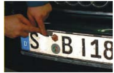
Định vít đơn giản; có thể tháo bằng tay Biển số được cố định; không thể tháo bằng tay Reinhard Kolke Reinhard Kolke
