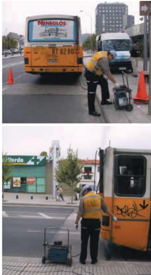
Hình 14 Kiểm tra khí thải định kỳ các xe buýt tại thời điểm chất đầy tải trên lực kế khung gầm
