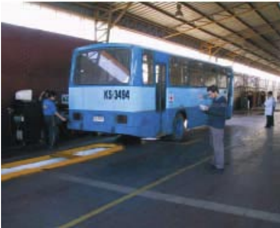
Hình 13 Kiểm tra khí thải định kỳ các xe buýt tại thời điểm chất đầy tải trên lực kế khung gầm
