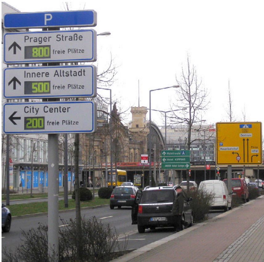
图十六 实时停车引导系统——显示不同地点免费停车位的数量
