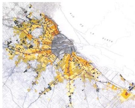
**Hình 24: Các tuyến đường sắt đô thị hình nan quạt đã tác động lớn đến sự hình thành đô thị ở Buenos Aires.**
