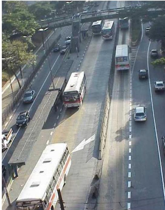
**Hình 5: São Paulo có mang lưới làn đường dành cho xe buýt trải rộng nhất trên thế giới với 28km đường xe buýt ở giữa và 137km làn đường xe dành cho xe buýt.**
