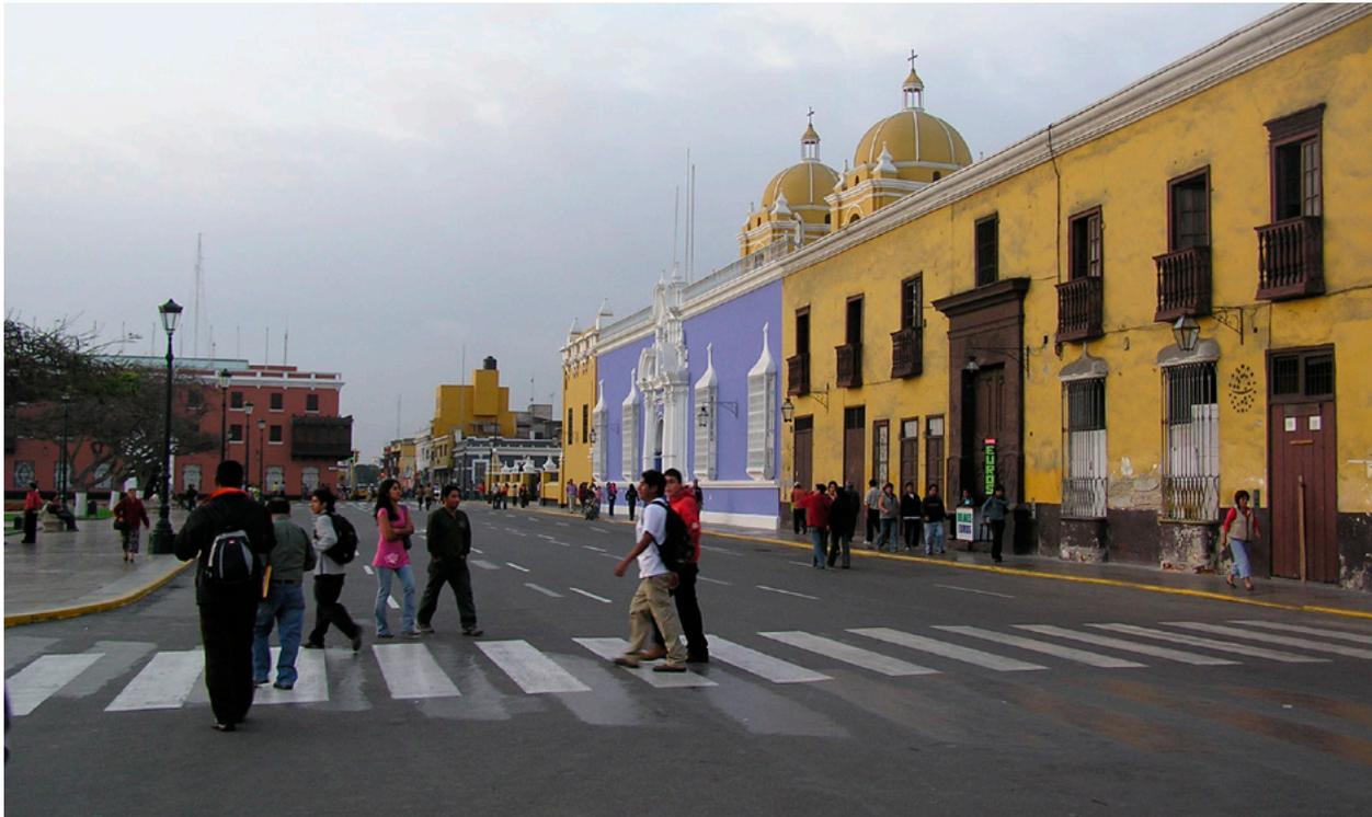
**Figura 16:** Faixas de pedestres são ferramentas úteis, mas só são adequadas se baixas velocidades são impostas, e fiscalizadas, e os cruzamentos são respeitados pelos motoristas. (Esse exemplo de faixa de pedestres no Peru não é bom. Onde mais de 2 faixas precisam ser atravessadas deve haver um refúgio para que pedestres possam parar e seguir a travessia em segurança.)
