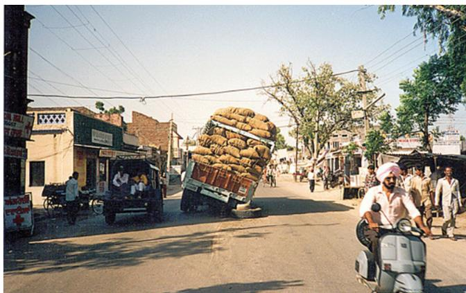
**Figuras 24 y 25:** La sobrecarga es una causa principal de las colisiones. Las ruedas anteriores de un camión cargado con troncos de bambú en Bangladesh (arriba) escasamente tocan el suelo, mientras que un camión sobrecargado en Amritsar, Punjab, India representa un serio peligro.
