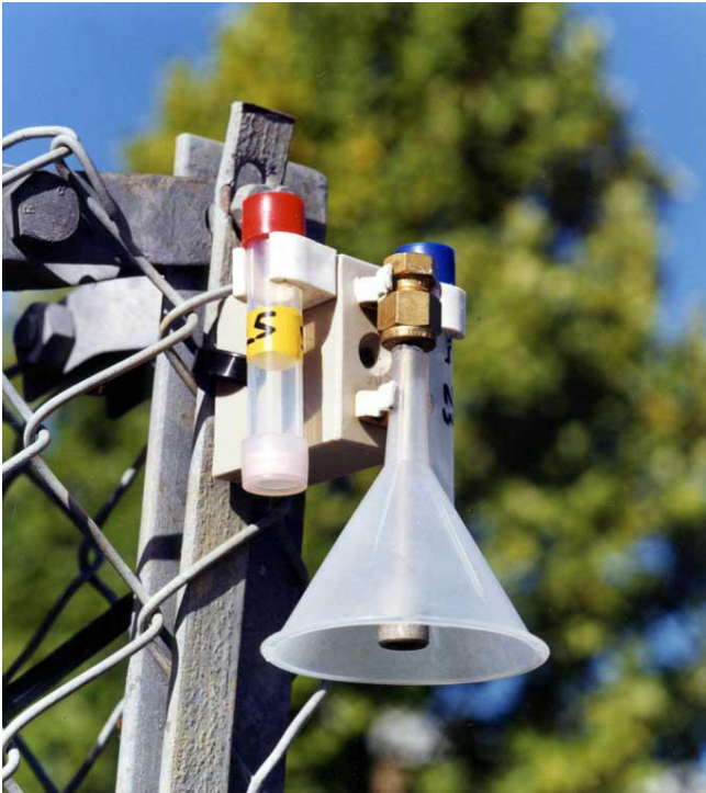
Hình 9. Bộ phận che chắn bảo vệ và lắp ghết thiết bị tốt rất quan trọng trong điều tra lấy mẫu thụ động.
