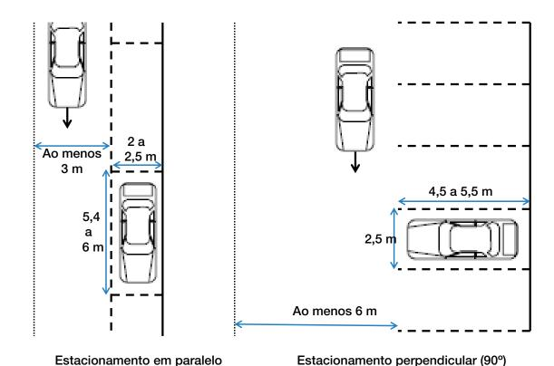
Fig. 28: Dimensões comuns para orientação de estacionamento em paralelo e perpendicular.
