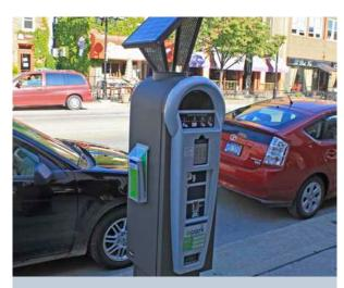
**Fig. 68:** Parquímetro inteligente (digital) multivagas em Ann Arbor.
