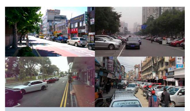
Fig. 30, 31, 32, 33: Orientações de estacionamento: em paralelo (superior esquerdo), perpendicular (superior direito), em ângulo (em inusitados 30°) (inferior esquerdo), perpendicular sem marcação (inferior direito). © Paul Barter
