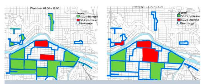
Fig. 72a, b: Mapas dos ajustes de preço para a manhã e meio do dia na abordagem de definição de preços em Calgary que utiliza metas de taxas de ocupação e zonas simples. © http://www.calgaryparking.com
