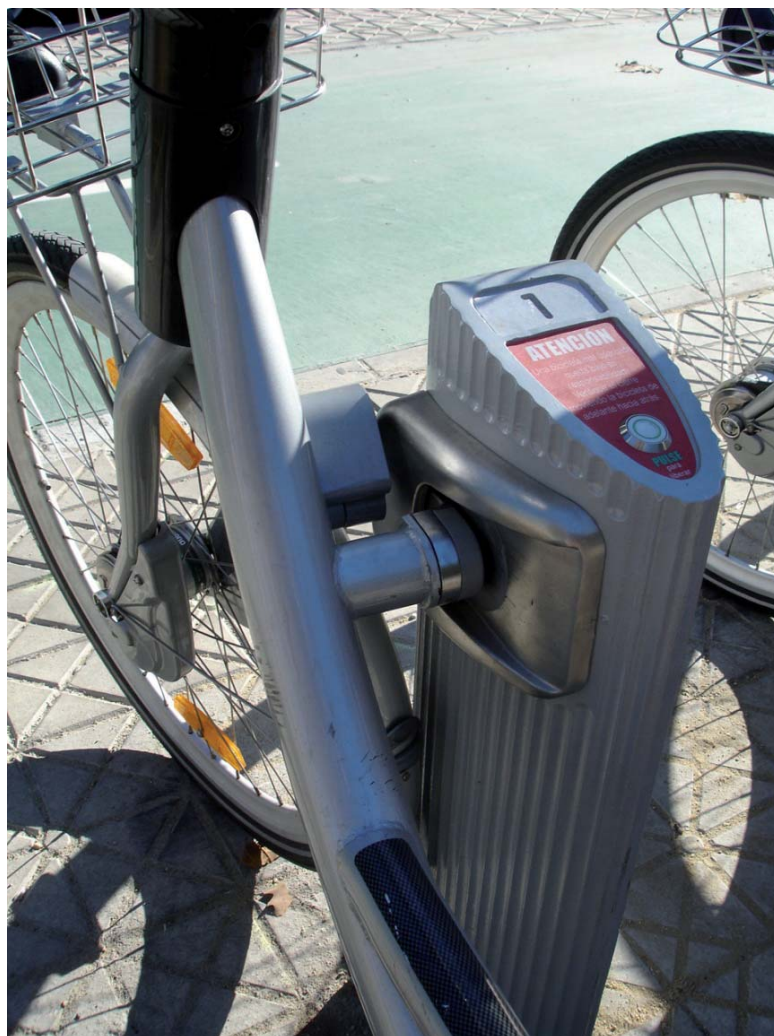
Sistema de bloqueo frontal de pedestal en el SBP Sevici de Sevilla (España). Un eficiente sistema en España, que se encuentra enmarcado en un Plan director de la Bicicleta. Fotografía: Jesús David Acero Mora.
