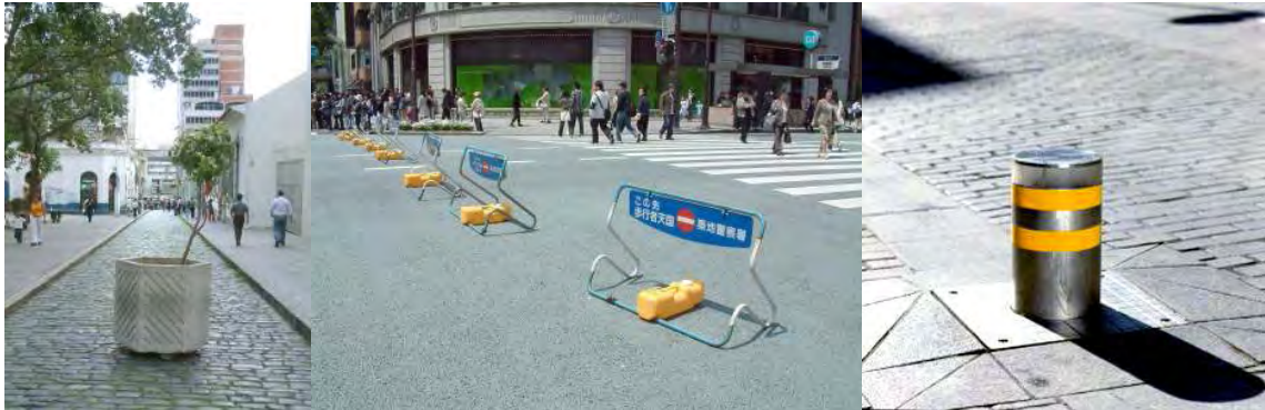
[그림 61] 차량 진출입 통제시설(화분, 이동식울타리 그리고 전자 블라드)
