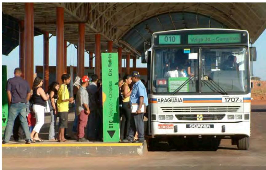
图69： 上车买票和检票的方式会大大减慢乘客上车速度，比如此图戈亚尼亚（巴西）的例子。 图片由劳伊德·赖特提供
