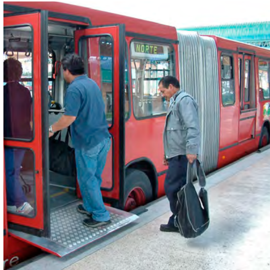
图51和52: 库里蒂巴使用的登车阶梯(上图)以及基多使用的登车设备创造舒适和安全性(下图)。
