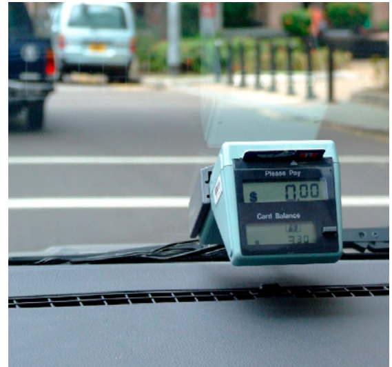
Gambar 22a, b Gerbang Electronic Road Pricing (kiri) dan alat penarikan tarif dalam kendaraan (on-board) (kanan) di Singapura.
