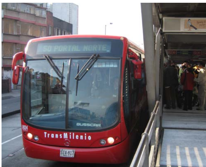
Gambar 50 Stasiun BRT ditempatkan di jalur jalan raya. Jalur khusus menghasilkan waktu perjalanan yang lebih singkat.
