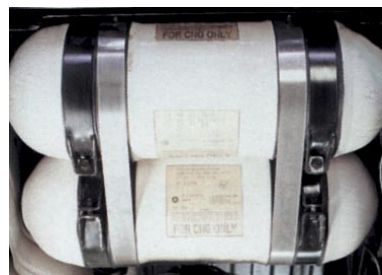
图 16: 安装在后部 的燃料罐 (Ruhrgas AG)
