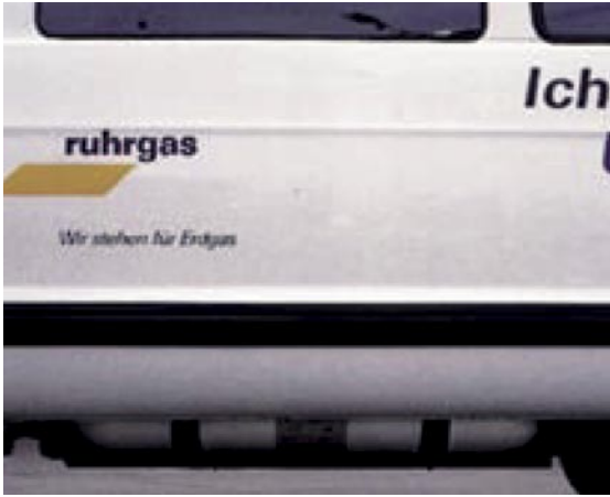
图 17： 侧视：车下的高压油罐 (Ruhrgas AG)
