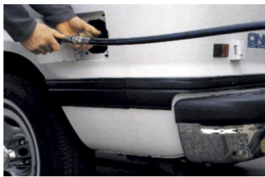
图 15: 装有塞子的 高压管 (Ruhrgas AG)
