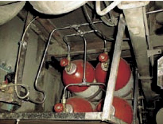
图 24： 改造公交车中没有压力释放环和气压不足报警装置 的 CNG 管道 (科学与环境中心, Erlandsson 和 Weaver, 2002)
